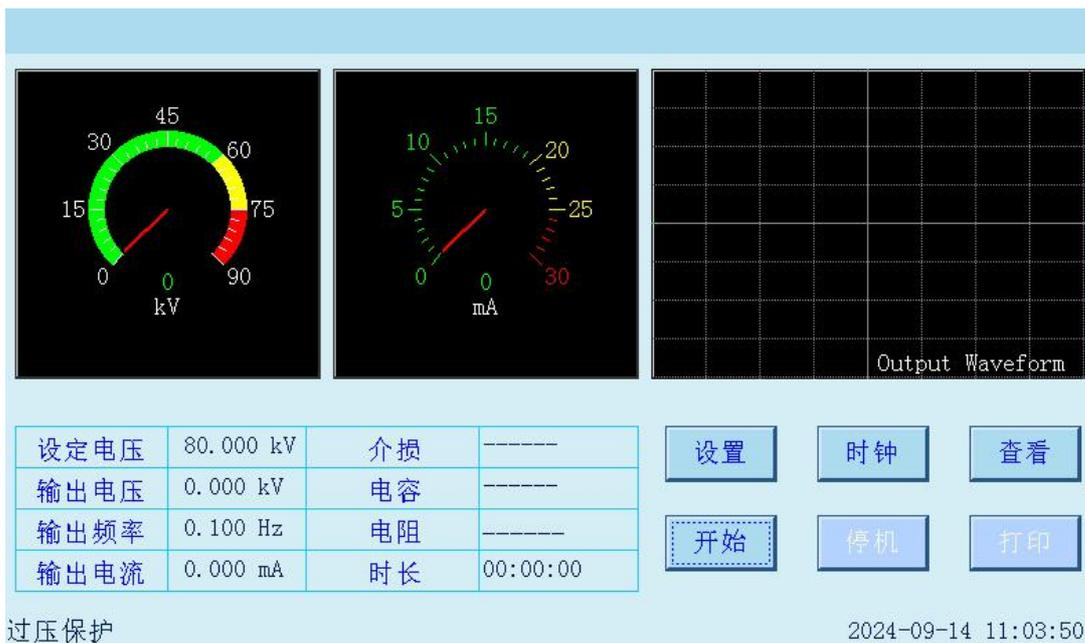
图 12 控制器提示过压保护
